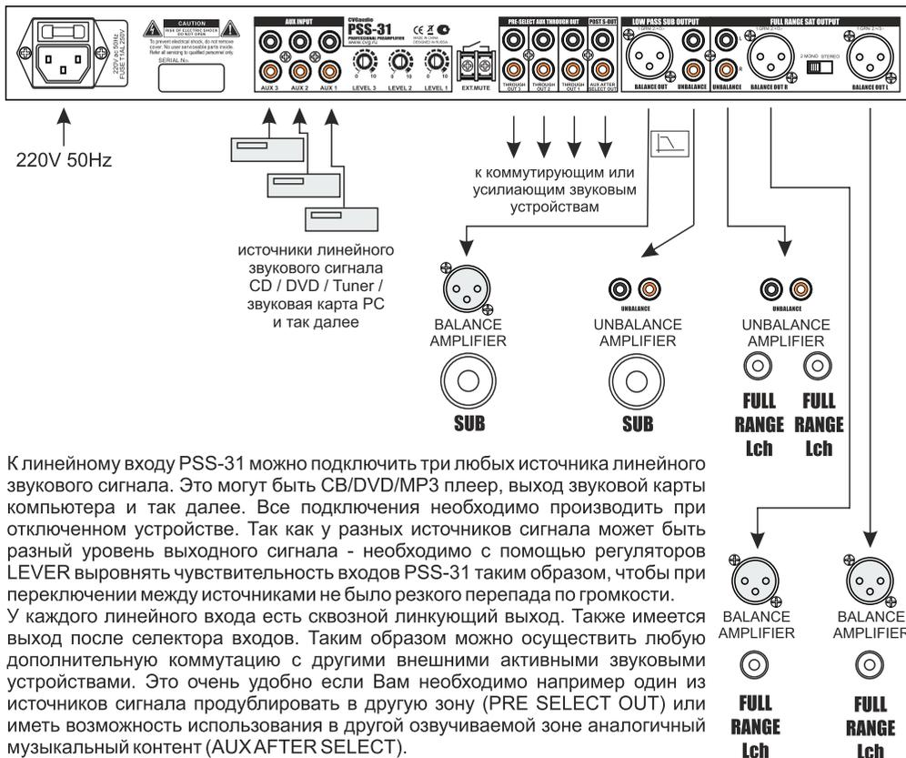
К линейному входу PSS-31 можно подключить три любых источника линейного звукового сигнала. Это могут быть CB/DVD/MP3 плеер, выход звуковой карты компьютера и так далее. Все подключения необходимо производить при отключенном устройстве. Так как у разных источников сигнала может быть разный уровень выходного сигнала - необходимо с помощью регуляторов LEVER выровнять чувствительность входов PSS-31 таким образом, чтобы при переключении между источниками не было резкого перепада по громкости.
