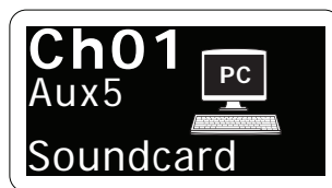
Пример: Канал "Ch01" имеет название "Soundcard" (Звуковая карта) и источник входного сигнала "Aux5" (Дополнительный вход 5).
